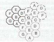
Fig. 2.26 Frequency Reuse
